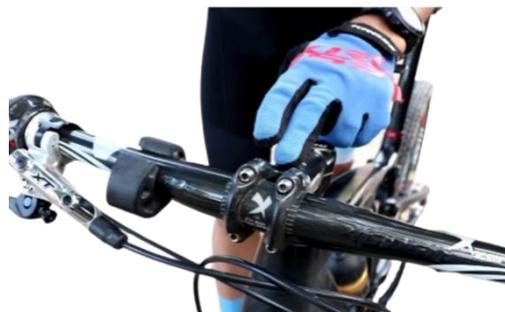
2- Coloca el manubrio en posición utilizando las guías marcadas en el mismo coloca la ontraparte de potencia y ajusta.
