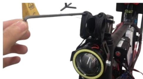
**Nota:** el manubrio de tu bicicleta va desensamblado, para ensamblarlo debes utilizar los tornillos que vienen en la potencia, utilizando una llave Allen de 4 ms.
