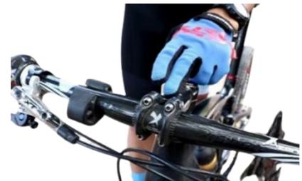
Nota: el manubrio de tu bicicleta va desensamblado, para ensamblarlo debes utilizar los tornillos que vienen en la potencia, utilizando una llave Allen de 4mm.
