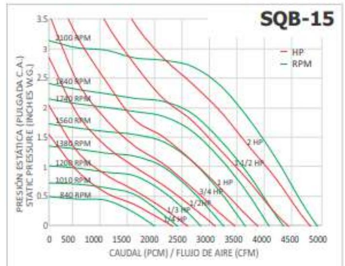
Todas las capacidades están basadas en la densidad estándar del aire de 0.075 lbs/ft<sup>3</sup> @ 70°F y 0 pies de elevación: 1.2 kg/m<sup>3</sup>@21°C y 0 mt. / (All capacities are based on the standard air density of 0.075 lbs/ft<sup>3</sup> @ 70 °F and 0 ft Elevation: 1.2 kg/m<sup>3</sup> @ 21 °c and 0 Mt.)
